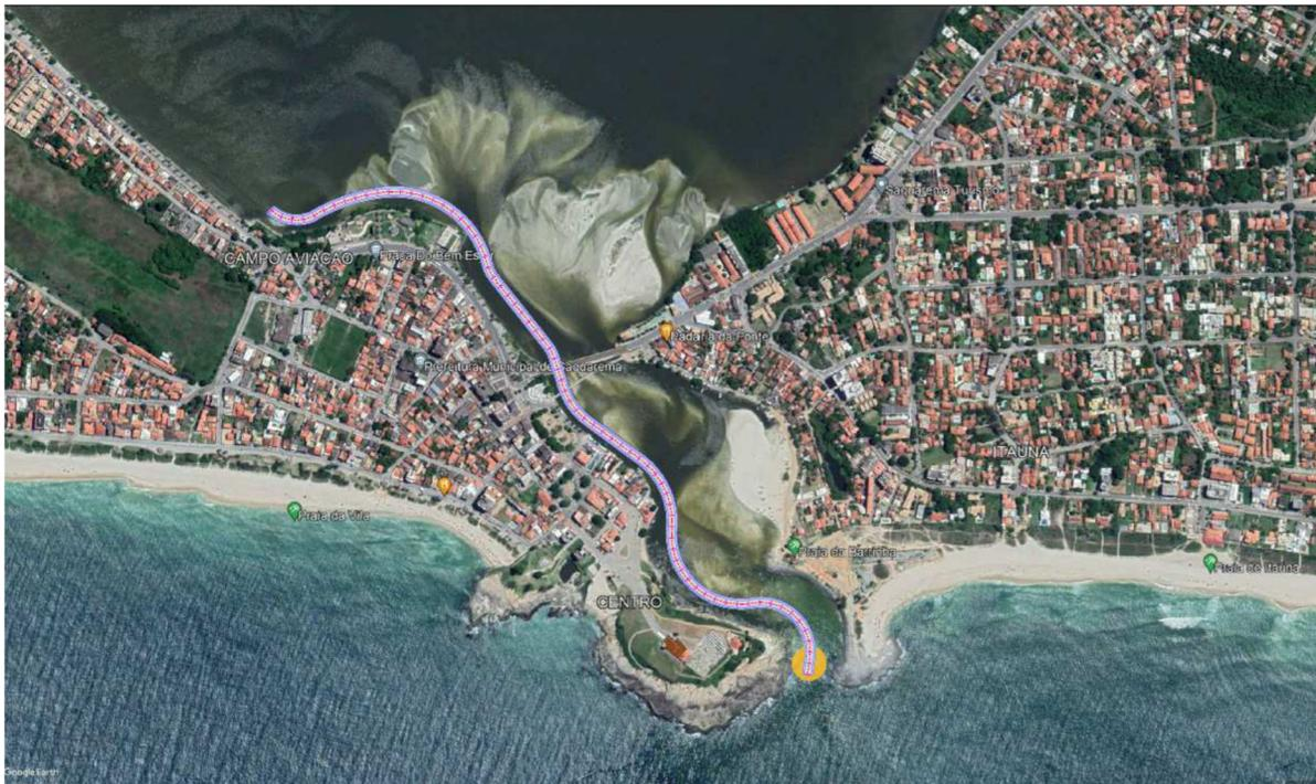
Figura 5 - Canal Hidráulico a ser executado. Em amarelo, região onde deverá ser realizada remoção de pedras.
